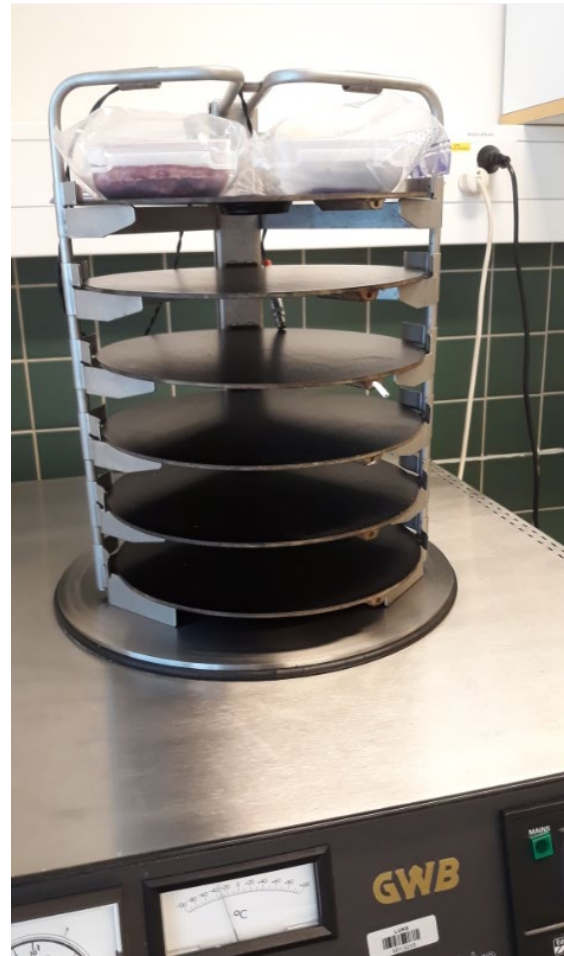
Näytteet pakattuna rei'itettyihin muovipusseihin, yksi rivi aseteltuna kuivuriin, ja suljettu kammio.
