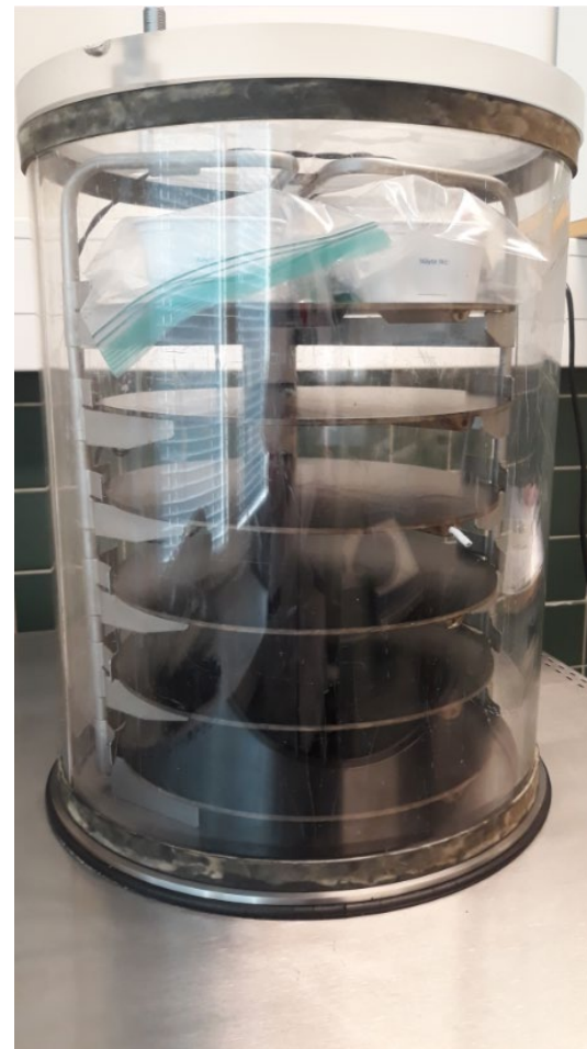
Näytteet pakattuna rei'itettyihin muovipusseihin, yksi rivi aseteltuna kuivuriin, ja suljettu kammio.
